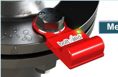
Beispiel: Direkte Messung der Montagevorspannkraft mittels einer Messunterlegscheibe
