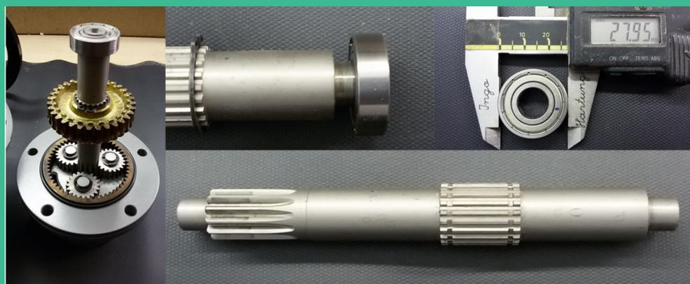
Abbildung 2: Zerlegung des Stellantriebs, Ausbau der Welle, Austausch des Wälzlagers, Ermittlung der Abmessungen, Zeichnen der Welle
