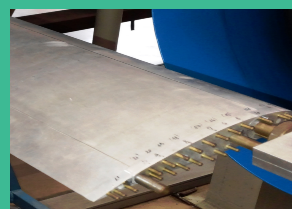
Tragflügelmodell im Windkanal der Hochschule Offenburg (links) und Vergleich der Druckverteilungen um das Tragflügelprofil aus Messung und Simulation (rechts).
