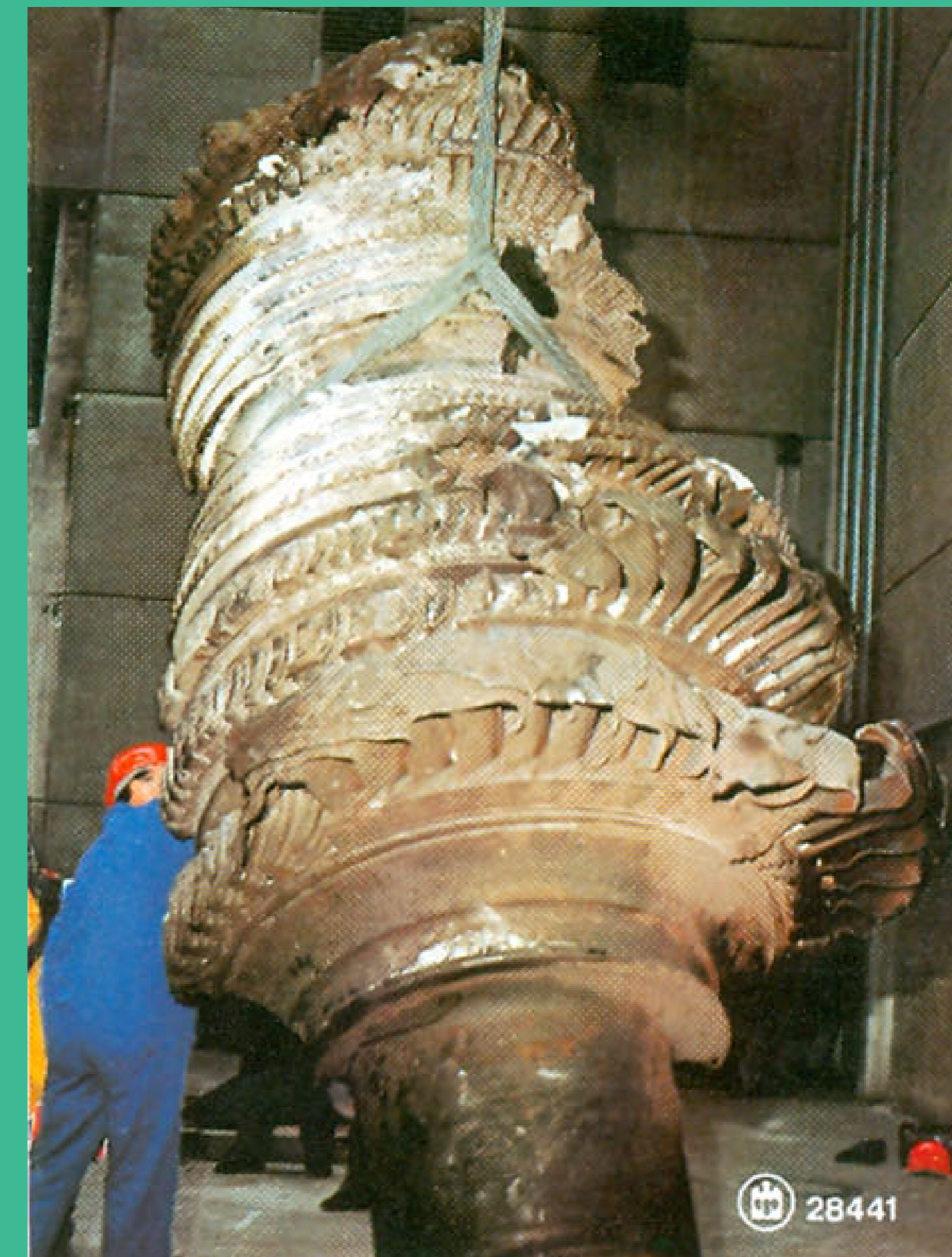
Geborstener Dampfturbinenläufer [AHL88]
