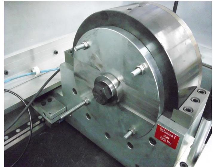
Die Untersuchung erfolgte an 50 lackierten Kopfaufbauteilen mit Schrauben M24 der Festigkeit 10.9. Die Messwerte sind arithmetisch gemittelte Werte.
